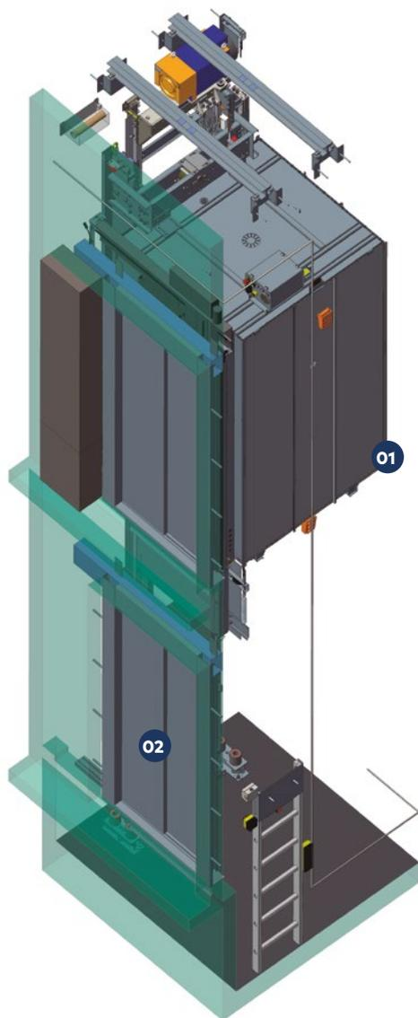
01 Las bases, suelos y techos de la **cabina** junto con el chasis están fabricados en chapa galvanizada de alta resistencia que aporta una gran robustez.
