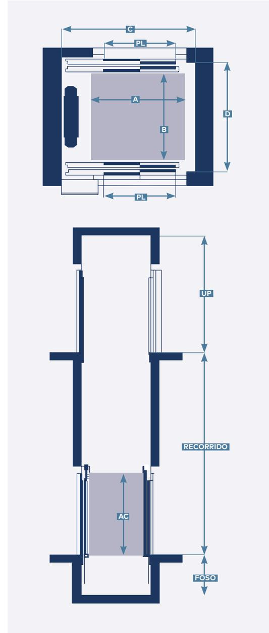
\* Puede llegarse a una UP de 3400mm si se retira la viga de montaje una vez terminada la instalación.
