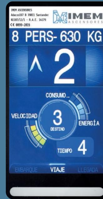
El sistema Smartech integra una pantalla TFT que muestra al pasajero toda la información relevante del viaje, con una visualización clara, moderna y altamente funcional.
